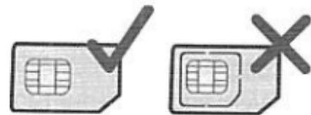
Setzen Sie die SIM-Karte in den Steckplatz ein. Stellen Sie sicher, dass die SIM-Karte richtig herum eingesetzt ist, wie in Abbildung 2 dargestellt, und schieben Sie die SIM-Karte in den Steckplatz.
